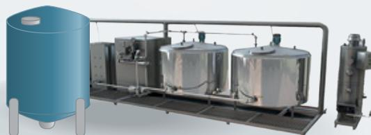
La leche almacenada es centrifugada para eliminar las impurezas y los microorganismos al 90%; luego es pasteurizada en línea y los microorganismos son eliminados al 100%. La leche es enfriada a temperaturas menores de 6 °C y almacenada. Queda lista para la elaboración de leche evaporada.
